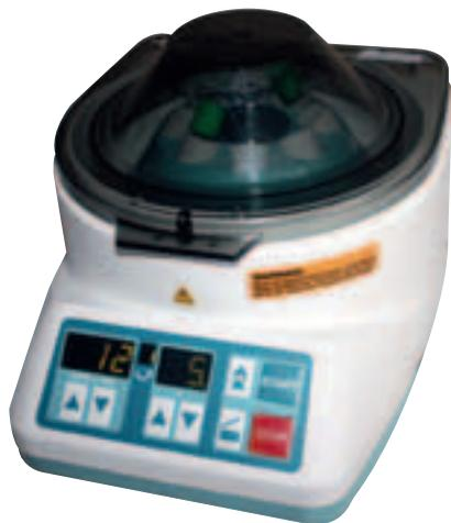
Рис. 1. Центрифуга EBA20 (Andreas Hettich GmbH & Co, Германия). Разделение крови на форменные элементы производится по градиенту плотности
